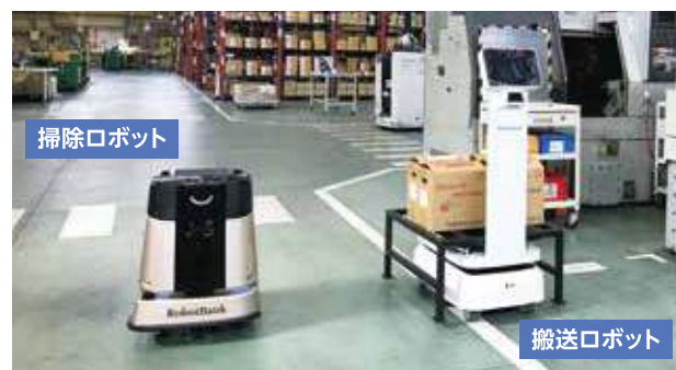
夜間に活躍する掃除ロボット。搬送ロボットはレールなしで自律走行が可能のため、頻繁なレイアウト変更にも柔軟に対応できる
